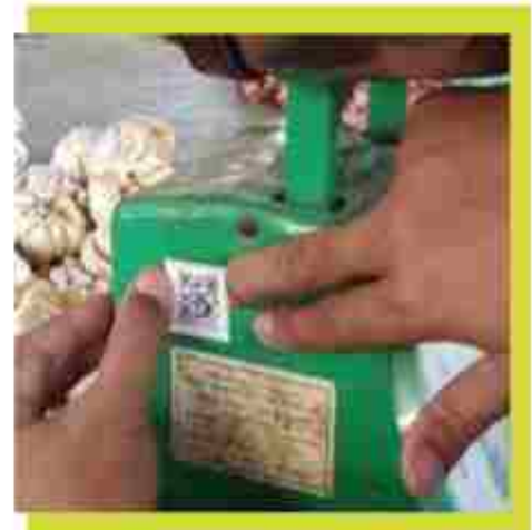
Gambar 3. Desain QR Code dan Penempatannya pada UTTP
